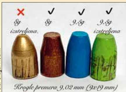
Slika 9: Krogle premera 9 mm, izstreljene in neizstreljene
