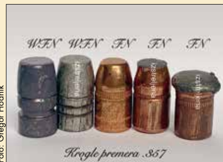
Slika 10: Krogle naboja .357 Mag., ploski vrh, izstreljene in neizstreljene
