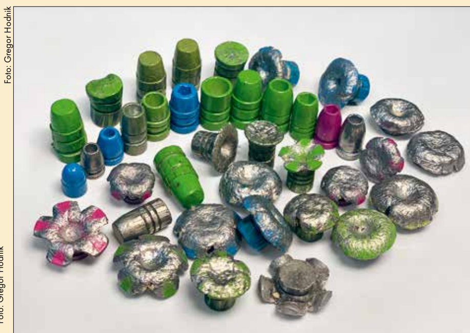
Slika 5: Razširne (ekspanzijske) in nerazširne svinčenke za kratkocevno orožje
