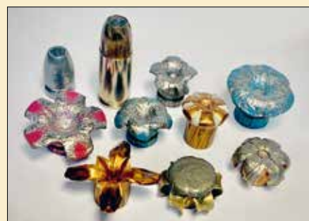
Slika 4: Hitro odpirajoče se ekspanzijske krogle 9 mm in .44 (.429")
