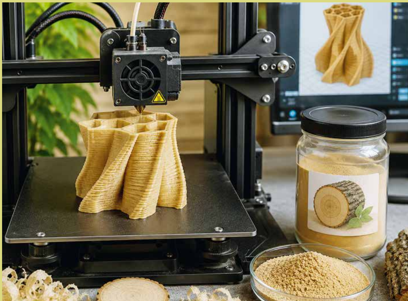
Tiskanje s 3D-tiskalnikom z lesnim prahom
